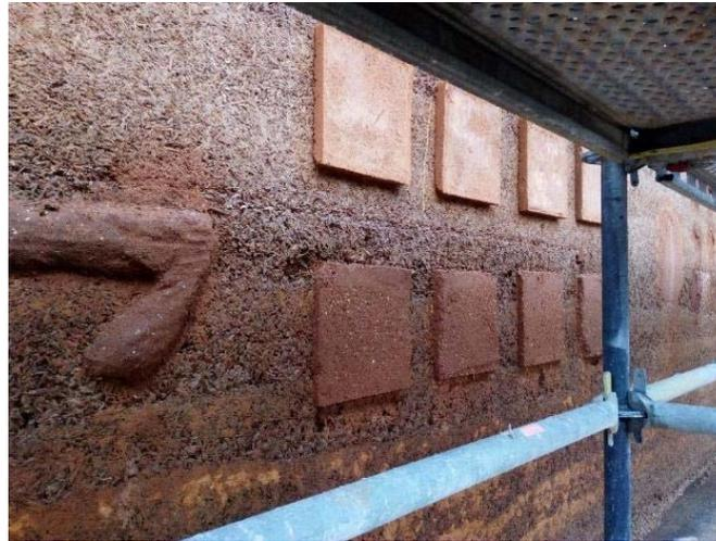
Réalisation de test : terre / sable
